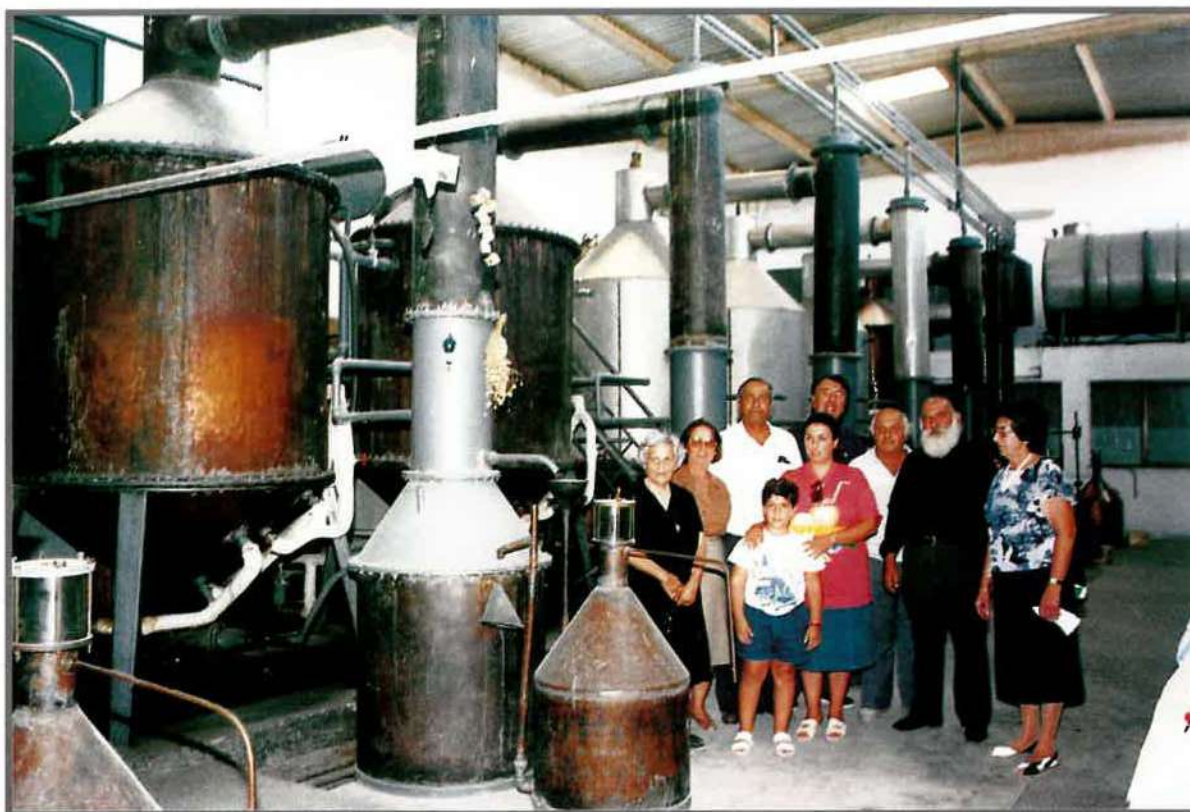
Εγκαταστάσεις επεξεργασίας και απόσταξης για την εξαγωγή του ροδέλαιου.
